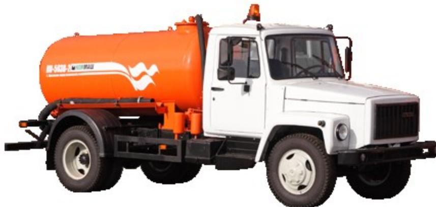
Рисунок 7.1. Вакуумная машина КО-503В
