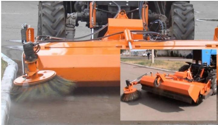
Рисунок 6.1. Щеточное оборудование на МТЗ ЩФС 2.0
