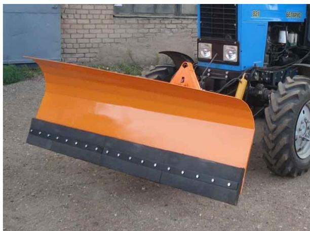
Рисунок 6.5. Отвал для снега СО 2.5
